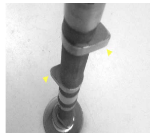
圖4 積架-E系汽車引擎的凸輪軸，箭咀標示兩個凸輪瓣。
